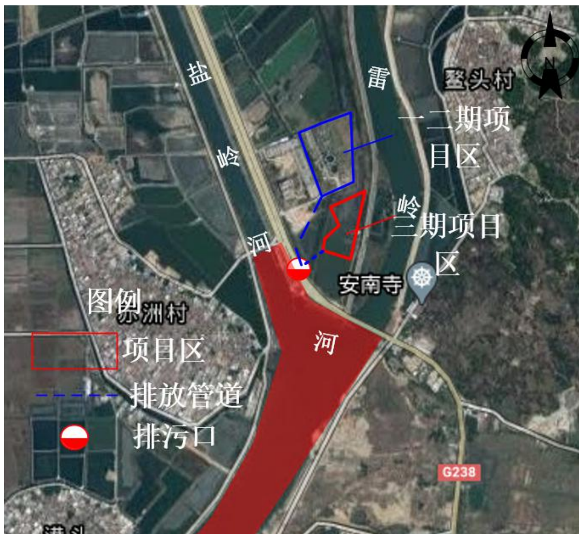
附图 13：排污口位置及尾水排放管道图
