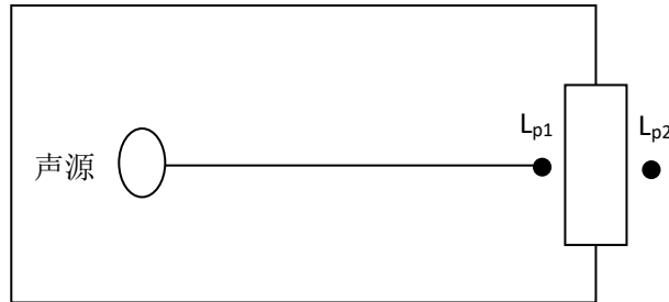
图 4-3 室内声源等效为室外声源图例
