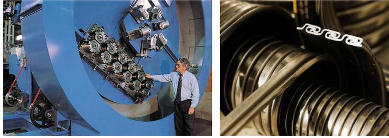
图 2-4 骨架层生产设备及辊弯成型工艺
