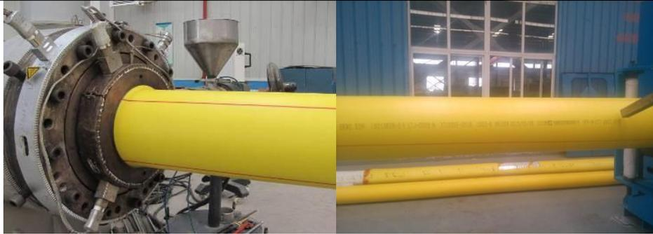
图 2-8 外包覆层挤出工艺
