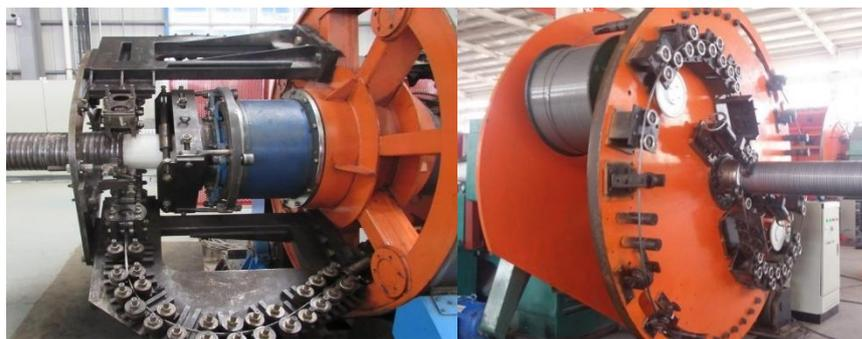
图 2-5 抗压层异形钢带锁扣铠装工艺
