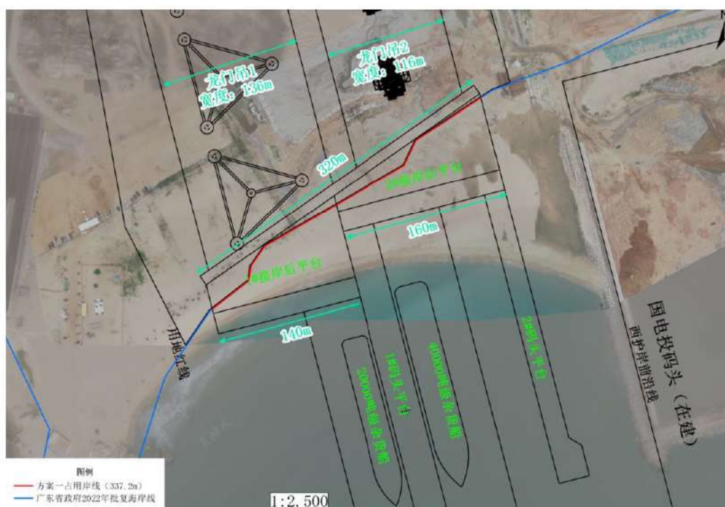
图 7.3.2-1 项目接岸平台布置示意图
