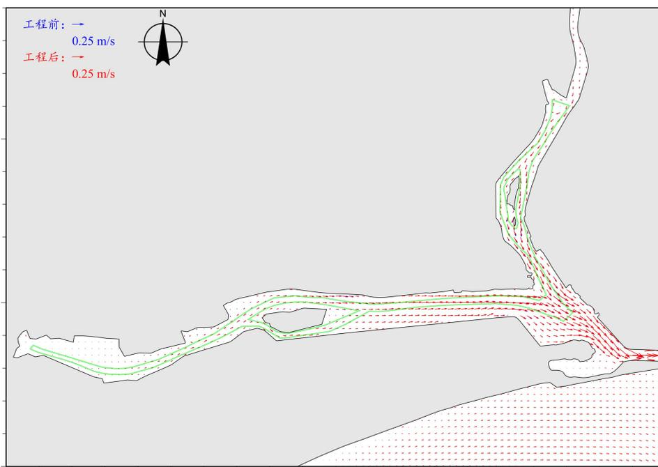
图 4.1.4-10a 工程前后落急流场对比图（方案一）
