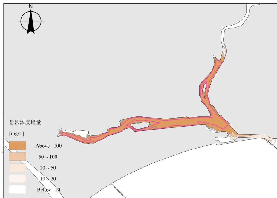
图 4.1.6-2b 施工悬沙浓度增量包络线图（方案二）
