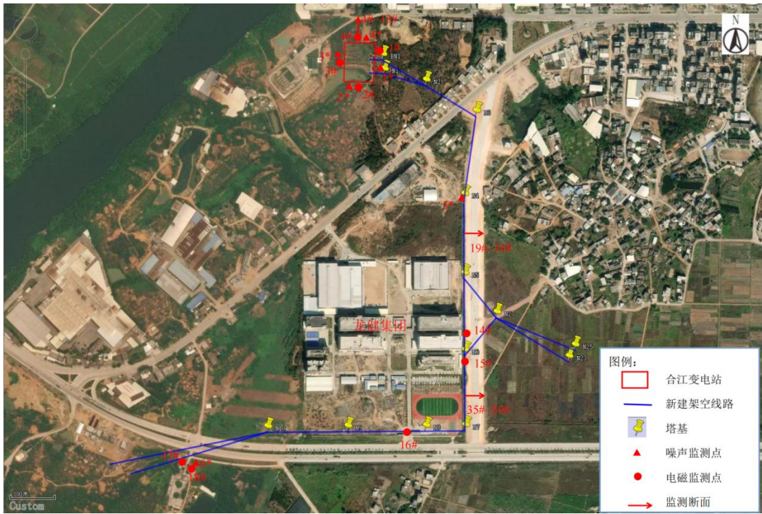
图 2 110kV 合江站监测布点图
