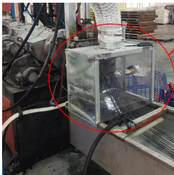
图 4-1 挤出机挤出口半密闭集气罩安装实例照片
