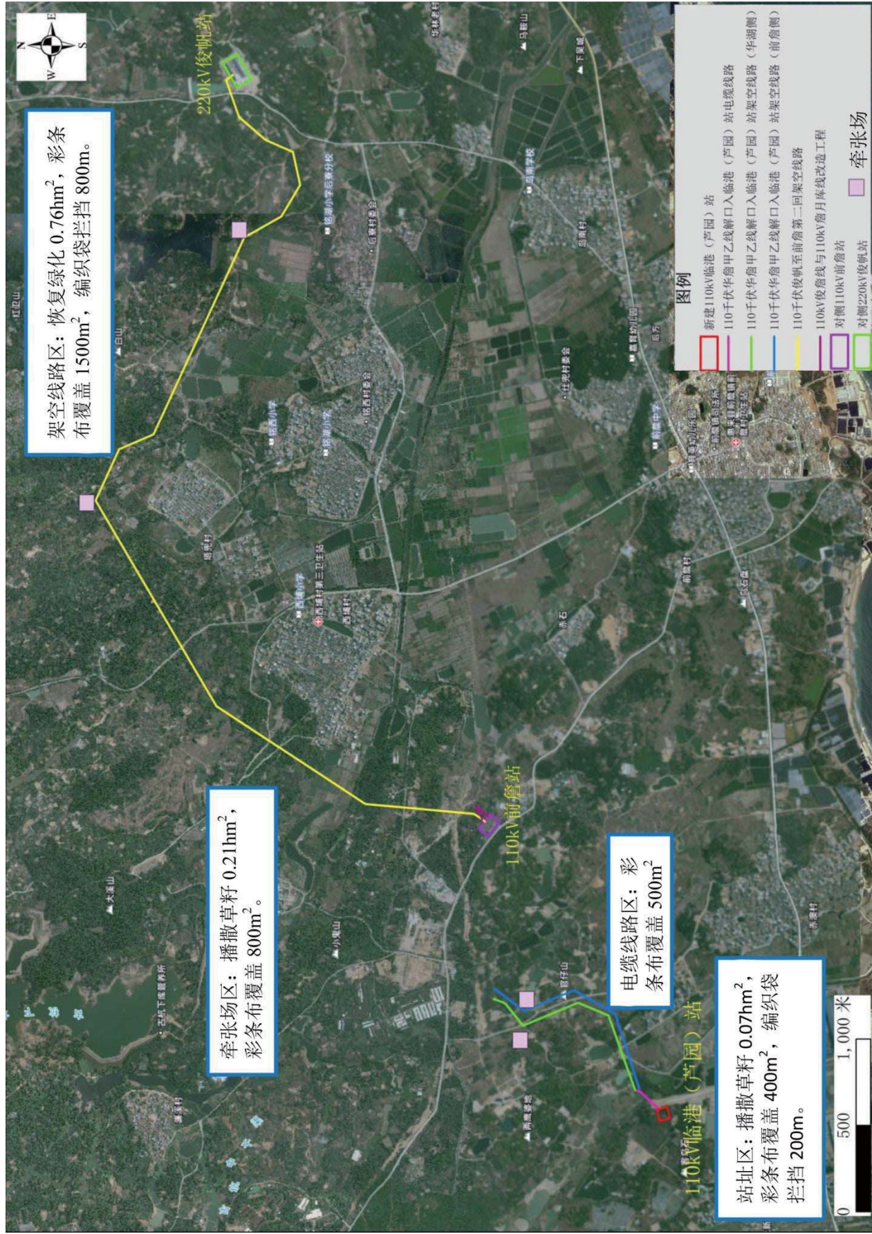
附图 21 施工总布置图及生态环境保护措施平面布置示意图
