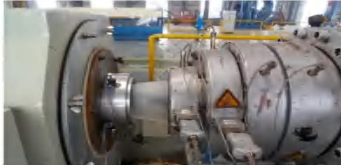
图 2-3 内衬层挤出工艺
