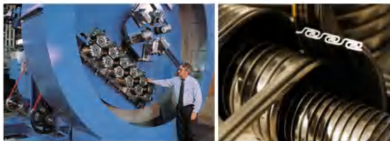
图 2-4 骨架层生产设备及辊弯成型工艺
