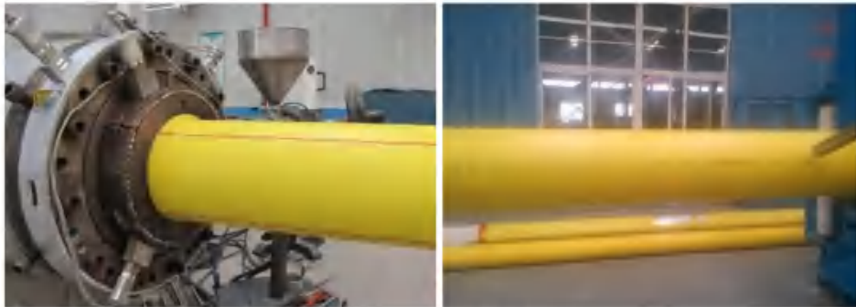
图 2-8 外包覆层挤出工艺
