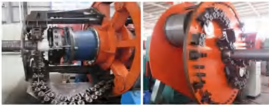
图 2-5 抗压层异形钢带锁扣铠装工艺
